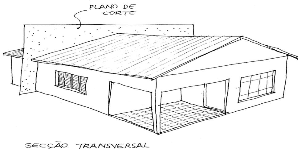
Processo de obtenção de um corte em desenho arquitetônico
