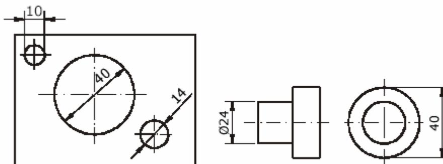
Para a cotação de pequenos detalhes, deverá proceder-se conforme os exemplos ao lado. As cotas deverão ser distribuídas entre todas as vistas. Cada detalhe deverá ser cotado uma única vez, na vista que melhor representar a forma do mesmo. Deve-se indicar sempre as dimensões máximas (comprimento, largura e altura) entre as duas vistas a que tal dimensão seja comum. Deve-se evitar cotar linhas representativas de arestas não visíveis (tracejado).
