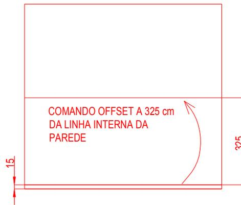
Figura - Utilização do offset para construção das paredes
