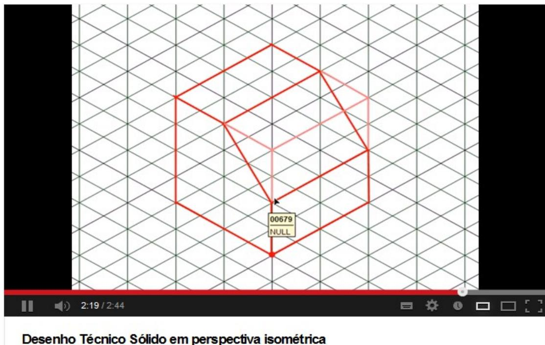
Ela representa graficamente as três dimensões de um objeto em um único plano, de maneira a transmitir a ideia de profundidade e relevo. A perspectiva isométrica mantém as mesmas proporções do comprimento, da largura e da altura do objeto representado.
