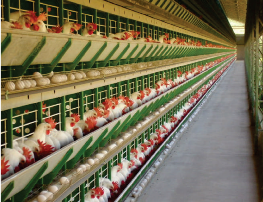
Figura 2. Sistema automatizado para alojamento de aves poedeiras
