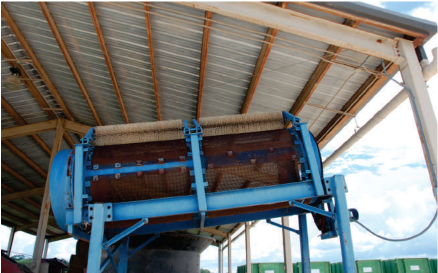
Figura 3. Peneira rotativa para peneiramento do composto
