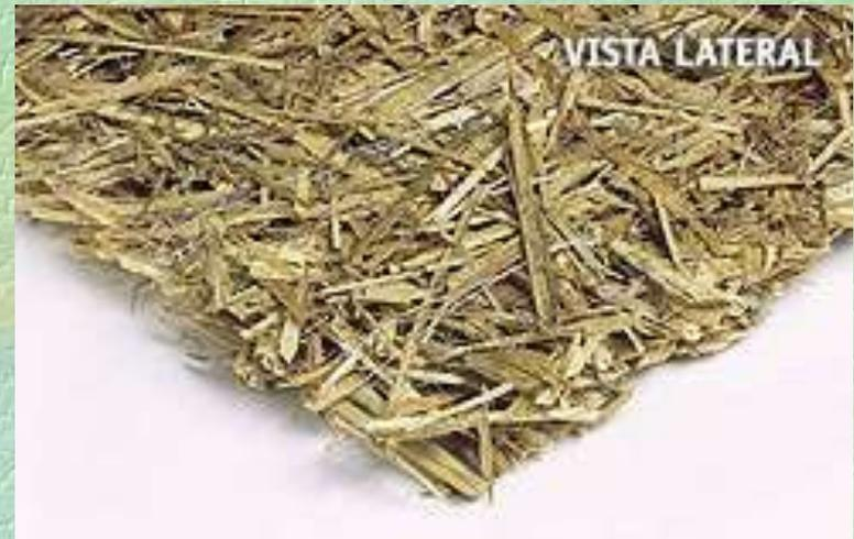
**Aplicações:** projetos de bioengenharia, áreas degradadas, rodovias, polidutos, ferrovias, aeroportos, projetos industriais, taludes de aterro e corte de até 60° de inclinação, minerações, gramados em geral. Indicado para solos de baixa a média suscetibilidade à erosão. Efeito paisagístico expressivo.
