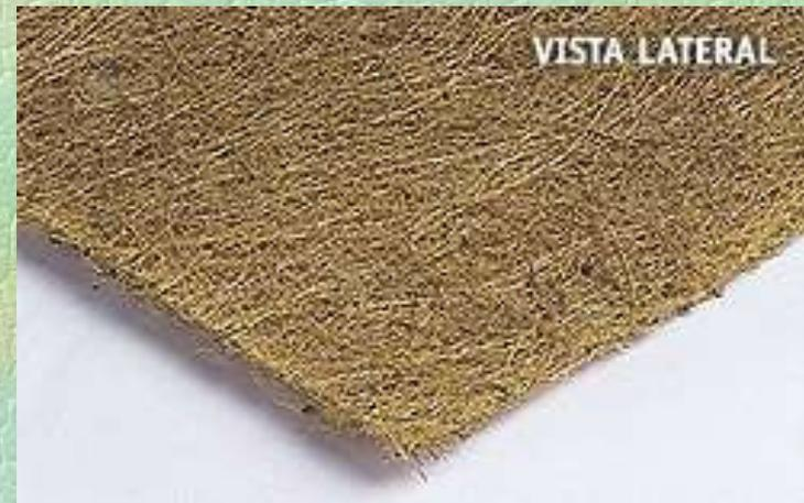
**Aplicações:** projetos de bioengenharia, áreas degradadas, projetos residenciais e paisagísticos, aeroportos, poldutos, ferrovias, rodovias, campos e gramados, proteção de aterro sanitário, proteção de cursos d'água e drenagens de médio fluxo. Indicado para taludes de corte e aterro de 60° de inclinação ou superiores. Efeito paisagístico de grande destaque.
