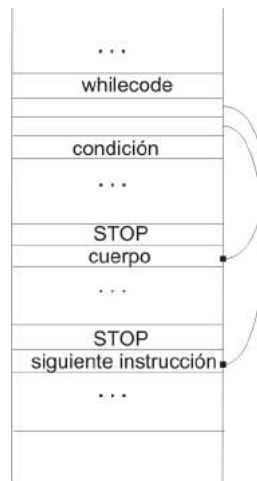
Figura 3.2: Máquina de instrucciones para la estructura while .
