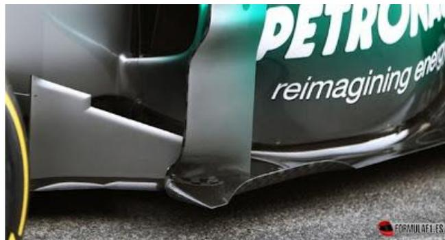
Ilustración 6.4: Elementos aerodinámicos laterales [24]
