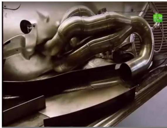
Ilustración 7.7: Soplador de aire hacia el difusor [30]
