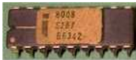
Figura. El 8008 contenía ya 3500 transistores en 1972
