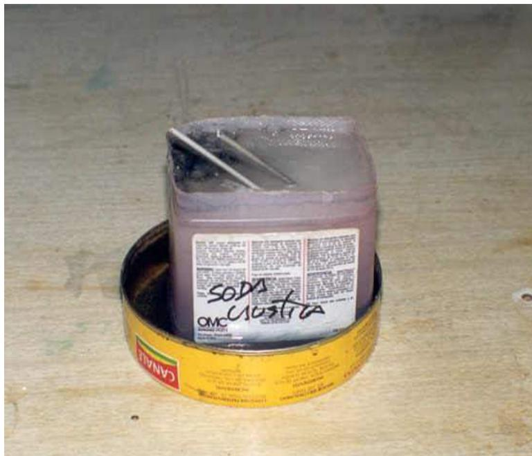
Una vez que tenemos las piezas firmemente unidas al conductor procedemos a desengrasarlas sumergiéndolas en una solución alcalina compuesta de Hidróxido de Sodio (soda cáustica) al 5% en agua, a una temperatura de 50 o 60° C. Mantenemos las
