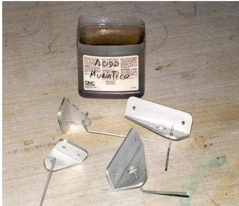
Luego del lavado las piezas deben sumergirse en una solución ácida para neutralizar cualquier vestigio que pudiera haber quedado del baño anterior, esta solución la preparamos con Ácido Clorhídrico (ácido muriático) al 50 % en agua a temperatura ambiente, (puede ser también Ácido Nítrico), sumergimos las piezas solo unos 2 a 5 segundo solamente y volvemos a lavarlas en abundante agua limpia.
