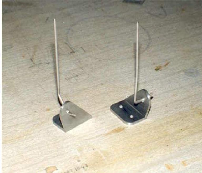
Algo muy importante es la forma en que se conecta la pieza al conductor de electricidad del cual suspendemos dentro del electrolítico, este debe ser también de aluminio ( puede utilizar el alambre redondo de aluminio que se adquiere en las casas especializadas en soldaduras y es muy maleable y económico ).
