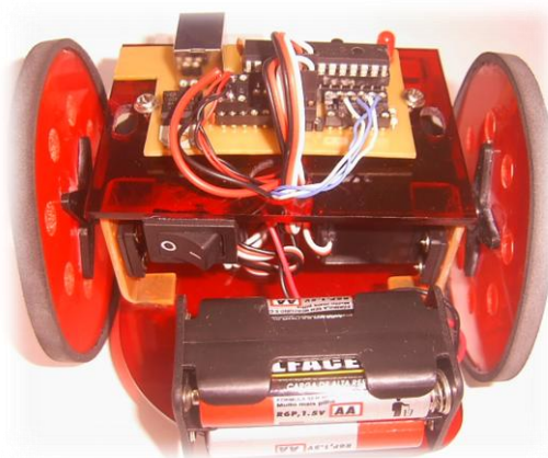
Figura 5.13 – Fixação das pilhas
