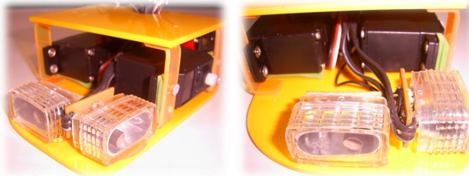
Figura 5.12 – Proteção dos sensores e fixação destes na base inferior
