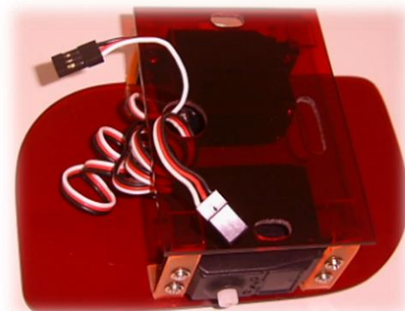
Figura 5.5 – Fixação dos 2 servo-motores
