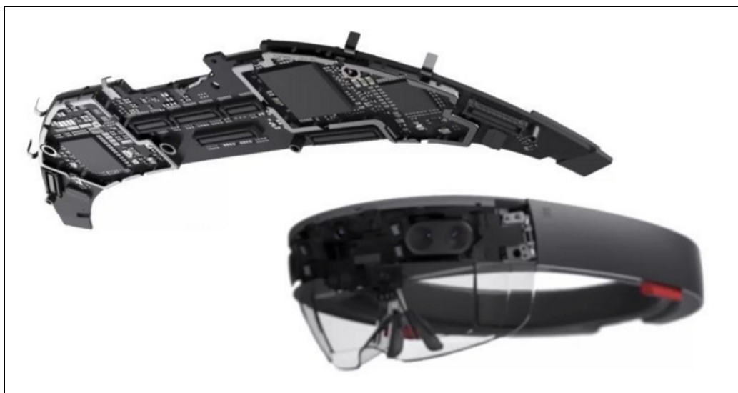
Figura 3.9: Sistema de processamento (CPU, GPU e HPU) do Hololens. Fonte: MICROSOFT (2016)
