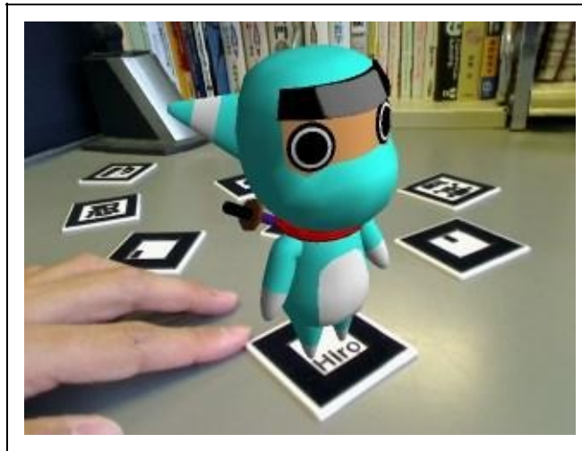
Figura 12.3.1 - Renderização de um objeto sintético utilizando o modelo de Phong de iluminação. Renderização feita com o biblioteca ARToolkit. Fonte: http://alternativeto.net/software/artoolkit/
