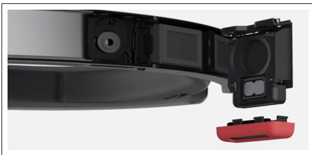
Figura 3.10: Sistema de áudio espacializado através de dois alto-falantes no Hololens. Fonte: Microsoft (2016)
