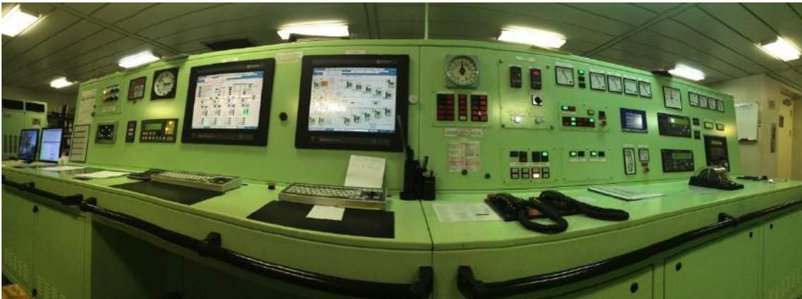
*Fig. 56 Cámara de control de la sala de máquinas*
