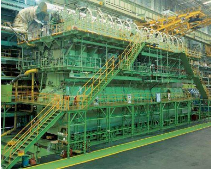
*Fig.19 El motor marino más potente fabricado por Wartsila, modelo 14RT-flex 96C (common rail e inyección electrónica) con 84 420 kW*
