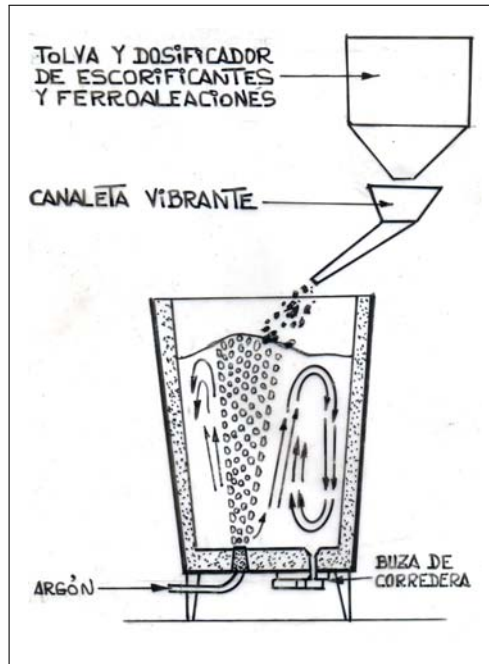
Figura 7.4: Purga de argón a través de tapón poroso A.P.
