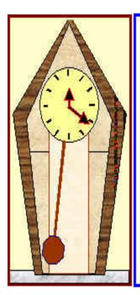
El tiempo T que la péndola de un reloj de péndulo tarda en dar una oscilación completa se llama periodo
