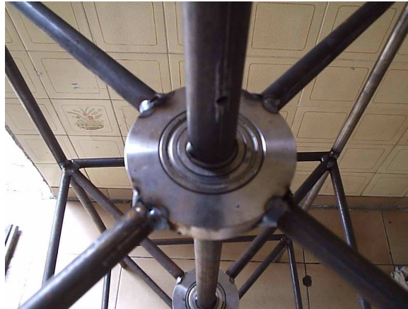
Figura 7.3 – Foto do rolamento posicionado no respectivo mancal
