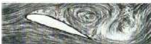
Figura 4.9 – Fluxo separado (estol) em volta do perfil. [4]
