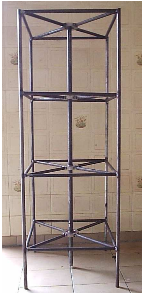
Figura 7.4 – Foto da estrutura do aerogerador Savonius
