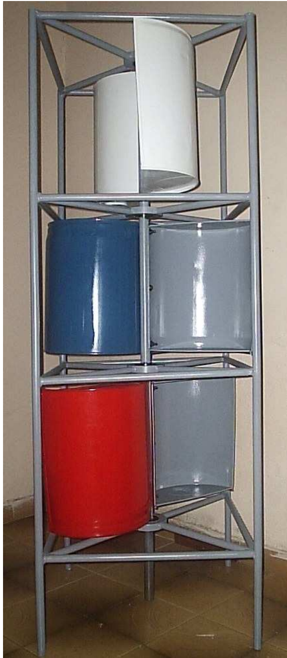
Figura 7.6 – Foto dos tambores Fixos no Eixo Vertical do rotor Savonius
