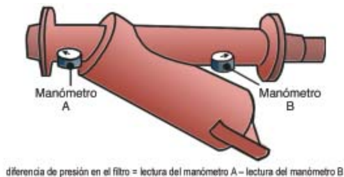
Figura 2. Determinación de la diferencia de presión existente a la entrada y a la salida de un filtro de malla.
