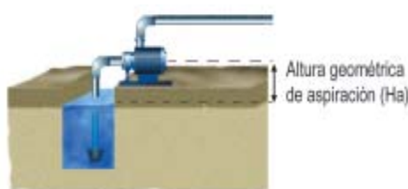
Figura 6. Representación esquemática de la altura geométrica de aspiración.
