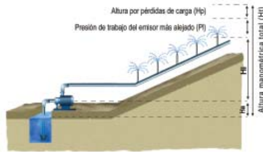
Figura 8. Representación esquemática de la altura manométrica total.
