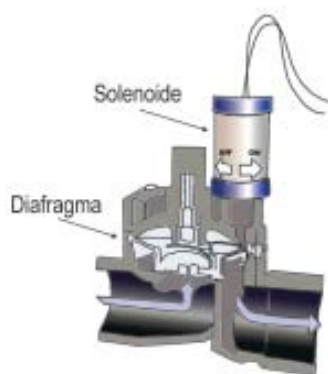
Figura 4. Representación esquemática de una electroválvula
