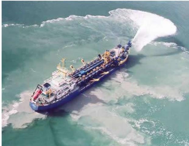
FIG 5.25 - Draga Auto-Transportadora pertencente à Dragaport
