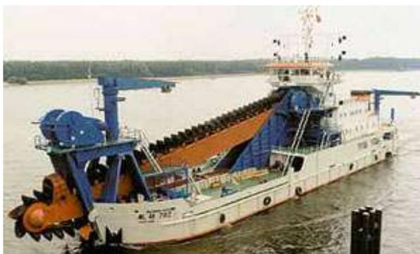
FIG 5.20 - Draga de Alcatruzes pertencente à Ballast Ham Dredging
