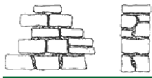
Pedras com aparelho parcial, dispostas em camadas.
