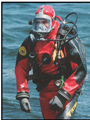
Foto 10-3 Roupa seca com capuz de látex, máscara full-face, luva seca, e equipamento autônomo de mergulho. Viking Diving Suits
