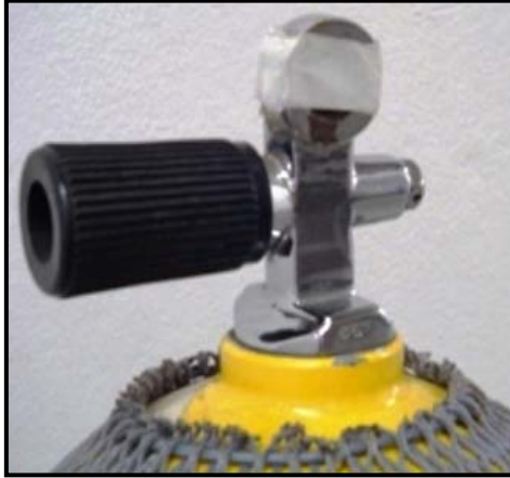
Foto 5-7 Torneira YOKE em cilindro de alumínio. Fita crepe sobre o o-ring e a saída de ar indica que o cilindro está cheio. Rede sobre o cilindro protege a pintura, mas acumula umidade e sal, favorecendo a corrosão.
