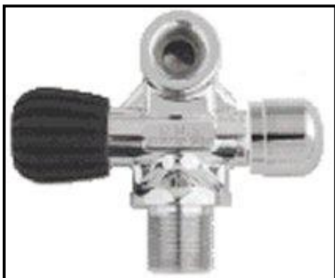
Foto 5-8 Torneira DIN A válvula é rosqueada à saída de ar, que tem rosca fêmea. O o-ring é localizado no assento da válvula e não na torneira.
