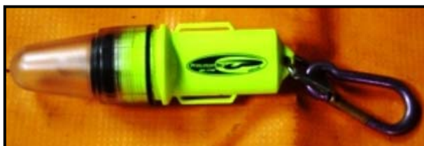
Foto 5-43 Estrobo alimentado por uma pilha pequena AA.
