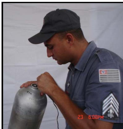
Foto 5-3 Realização de inspeção visual no interior do cilindro
