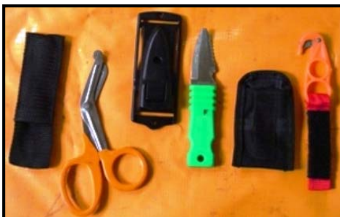
Foto 5-38 Posicionamento de ferramentas de corte Foto 5-39 Ferramentas de corte: tesoura, faca sem ponta, e corta-fio (Z-Knife)
