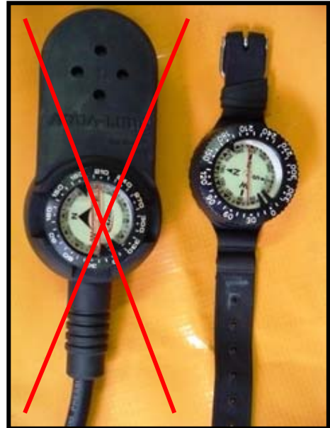
Foto 5-44 Bússola de console que deve ser evitada para os trabalhos no Corpo de Bombeiros, pois são mais susceptíveis a danos e quebra. E bússola de pulso.
