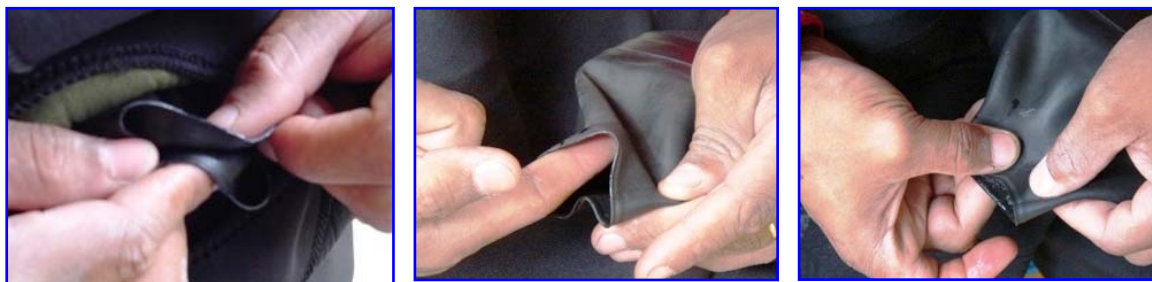
Fotos 6-18, 6-19 e 6-20 “Aquecendo” o selo de pulso . Lubrificando o selo de pulso
