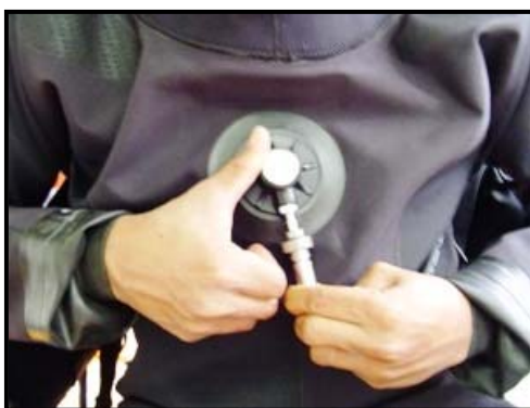
Fotos 6-34 e 6-35 Conectando a mangueira de inflagem, e testando o botão de inflagem
