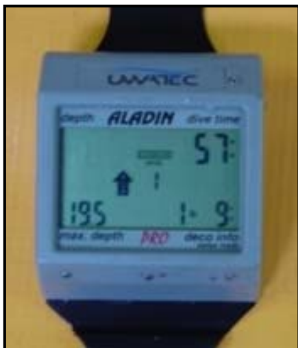
Foto 5-30, e 5-31 Computadores de mergulho de pulso Foto 5-32 Computador de mergulho no console devem ser evitados para os Bombeiros, pois são mais susceptíveis a danos e quebra SCUBAPRO - Uwatec
