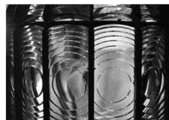
Lentes de Fresnel de un faro
