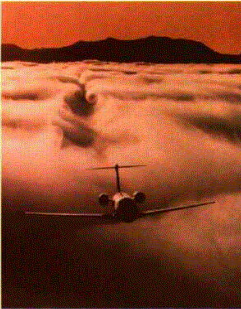
FIGURA 6 Muestra el downwash y los vortices de punta de ala sobre la niebla.
