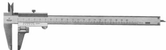
Paquímetro com bico de medição ajustável em posição vertical
