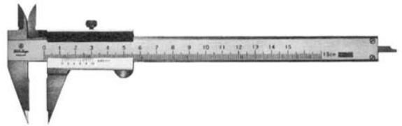
Paquímetro com bicos de medição externa, paralelos
