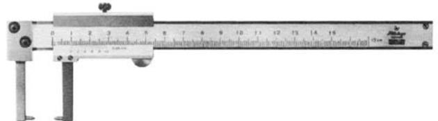
Paquímetro com um bico de medição em forma cilíndrica, para medir superfícies curvas
