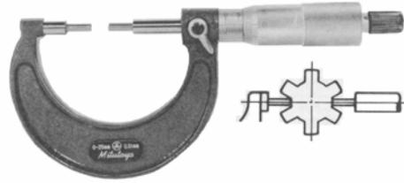
Micrômetro externo com pontas cônicas
