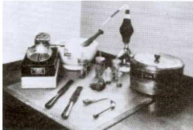
(a) Aparato de Casagrande para la determinación del límite líquido
