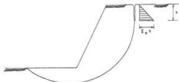
Figura 22 - Superfícies de ruptura associado a fenda de tração, preenchida com água.
