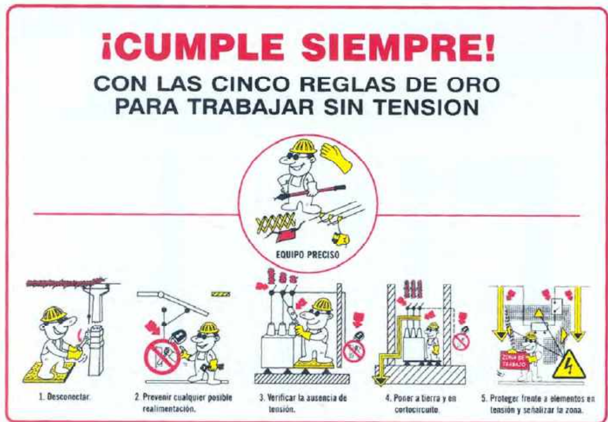
Figura 10-1; reglas de oro de la electricidad.
