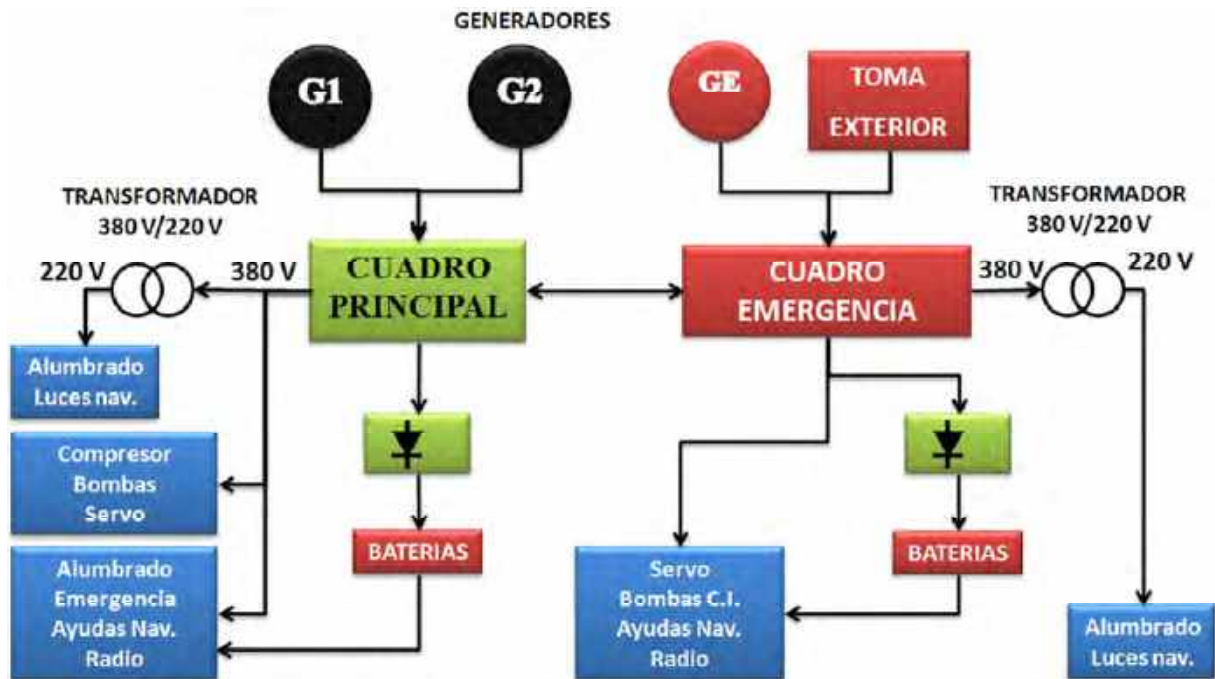
Figura 8-1; esquema general de la planta de un buque.
