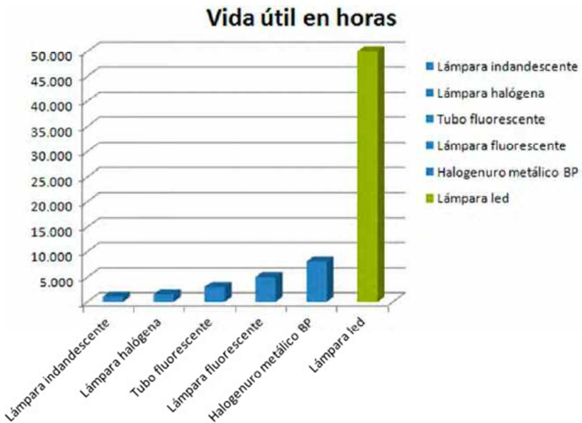
Figura 7-2; comparativa de la vida útil en horas de los distintos tipos de tecnologías de iluminación.
