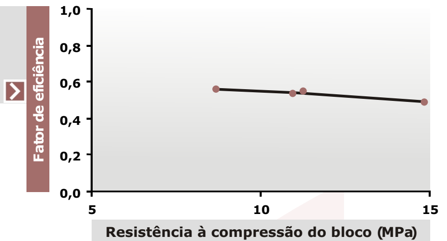
Figura 32 - Fatores de eficiência das paredes para diferentes blocos de concretos e argamassas (Medeiros) unidade (Prado, 1993).
