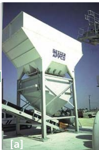
Figura 26 - a) Silo de armazenagem de agregados, dotado de correia transportadora com pesagem automática. b) Máquina de moldagem de blocos por vibro-compressão
