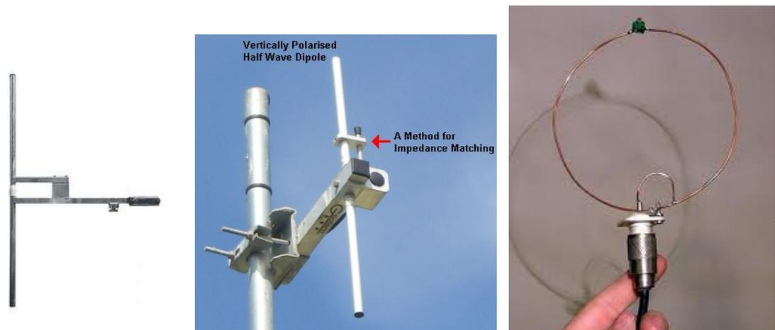
Figure 9.5: Antenas filamentosas típicas, como o Dipolo Elétrico e o Loop.
