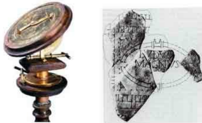
Reconstrucción de la dioptra, el más remoto antecedente del teodolito. El instrumento contaba con el llamado mediclinium, un vocablo que sería traducido al árabe y adoptado después por el castellano como alidada. A la derecha se representa una escuela de gladiadores, cerca del Coliseum, en un fragmento de la Forma Urbis Romae.
