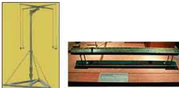
Reproducción de la Groma, conservada en el Museo de Nápoles, y codo real.
