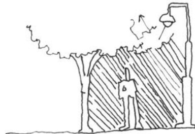
Fig. 37 Follaje que impide la iluminación.
