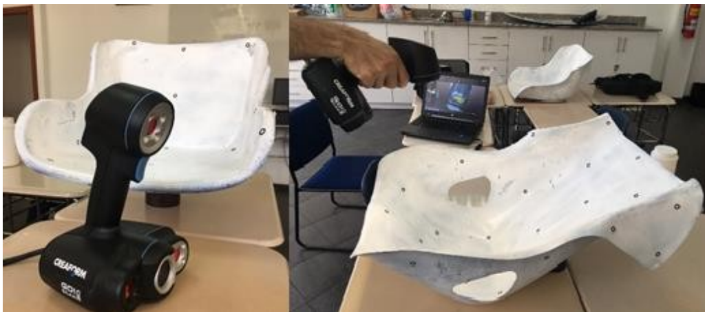
Figura 46. Escaneado de butacas utilizadas
