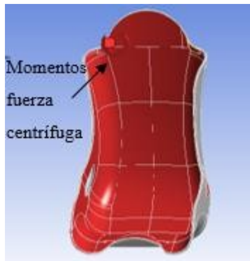
Figura 82 Momentos de torsión por fuerza centrífuga
