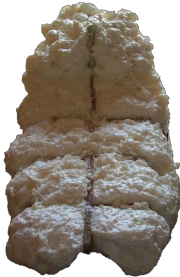
Figura 55. Moldeo de la butaca con espuma Poliuretano
