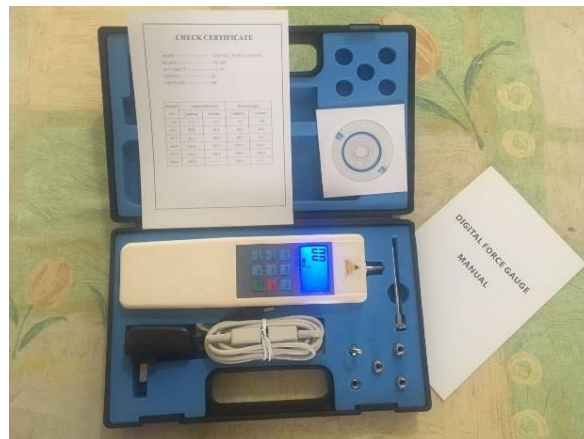
Figura 34. Medidor de fuerza digital de 200N
