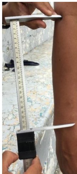
Figura 32. Calibre deslizante o antropómetro
