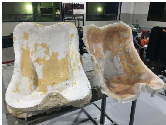
Figura 70. Extracción de la butaca
