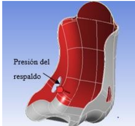
Figura 81. Presión del piloto sobre el respaldo de la butaca
