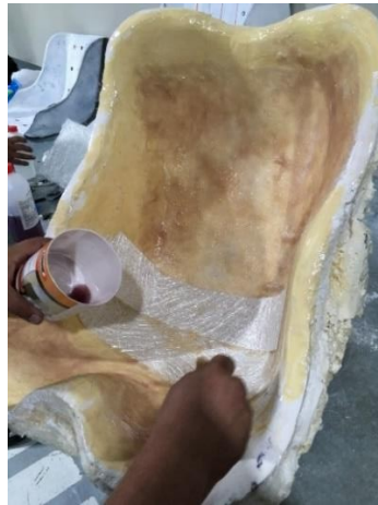
Figura 69. Fabricación de la butaca reforzada con fibra de vidrio
