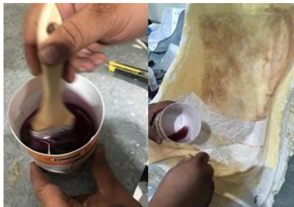
Figura 68. Laminado por vía húmeda
