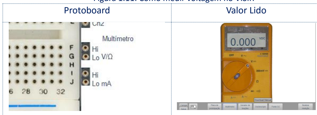
Figura 1.11: Como medir voltagem no VISIR
