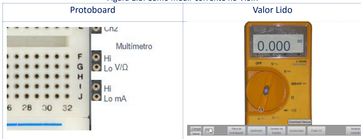
Figura 1.8: Como medir corrente no VISIR
