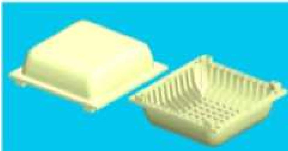
Figura 12 - Molde de caixa plástica da Protensão Impacto.
