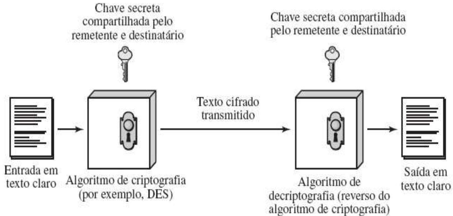
Figura 2.1 Modelo simplificado da criptografia convencional.
