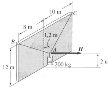
**2.75** Uma caixa está suspensa por três cabos, como ilustrado. Determine o peso *P* da caixa sabendo que a tração no cabo AB é de 6 890 N.
