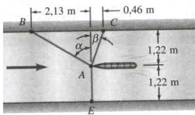
Como parte do dimensionamento de um novo veleiro, deseja-se determinar a força de arrasto que se pode esperar a uma dada velocidade. Para tal, coloca-se um modelo do casco proposto num canal de ensaios e usam-se três cabos para manter a quilha na linha central do canal. Para uma dada velocidade, as leituras dinâmométricas indicam forças de tracção de 180 N no cabo AB, e de 267 N no cabo AE. Determine a força de arrasto exercida no casco e a força de tracção instalada no cabo AC.
