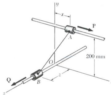
**2.98** Determine o intervalo de variação dos valores de  $P$  para os quais o módulo da resultante das três forças aplicadas em  $A$  não excede 1 125 N.
