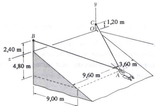
**2.88** Um recipiente pende de um cabo único, que passa através de um anel, sem atrito, e é atado aos pontos fixos  $B$  e  $C$ . Duas forças,  $\mathbf{H} = H\mathbf{i}$  e  $\mathbf{Q} = Q\mathbf{k}$ , são aplicadas ao anel, a fim de que o recipiente permaneça na posição ilustrada. Sabendo que o peso do recipiente é  $P = 376$  N, determine os módulos de  $\mathbf{H}$  e  $\mathbf{Q}$ . (*Sugestão: A tração é a mesma nas partes  $AB$  e  $AC$  do cabo.*)
