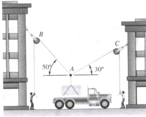
Se o peso do caixote de 736N, qual a força instalada em cada corda AB e AC.
