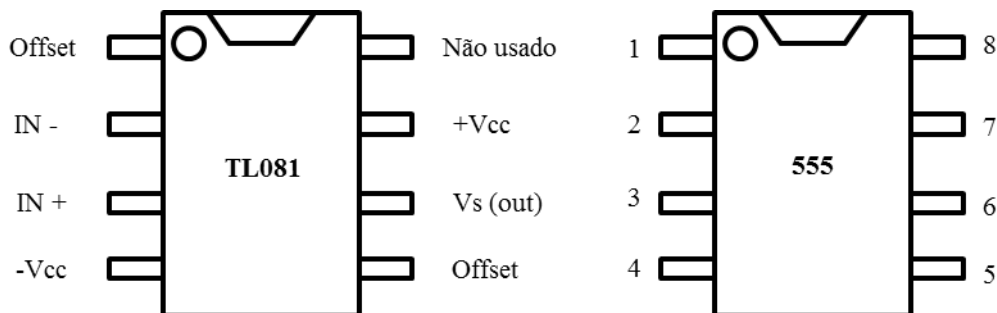
Figura 18 – Conexões de CI TL081 e CI 555
