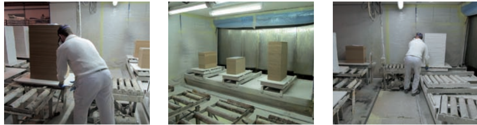
Figura 61. Sistema de transporte de piezas con rodillos.
