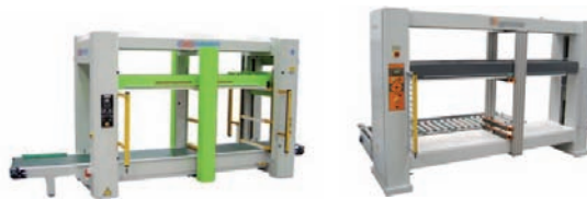
Figura 106. Prensas con carga y descarga automatizada.
