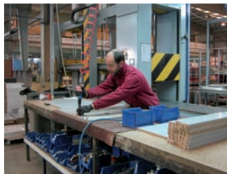
Figura 113. Sistema de sujeción contrabalanceado de la herramienta de mano.
