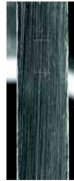
Fig 62: Formación de microfracturas en una lima Liberator
