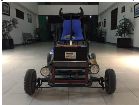
Figura 4. Montaje del sistema de iluminación en vehículo prototipo.
