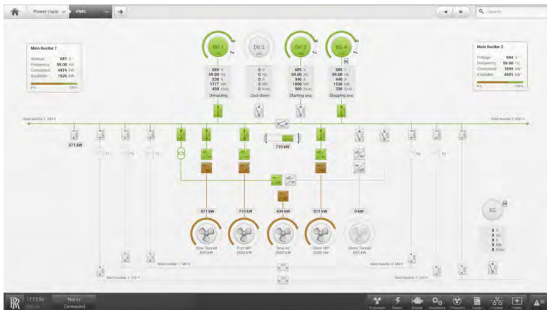
Ilustración 7.16 – Pantalla principal del sistema PMS (Rolls-Royce Marine)
