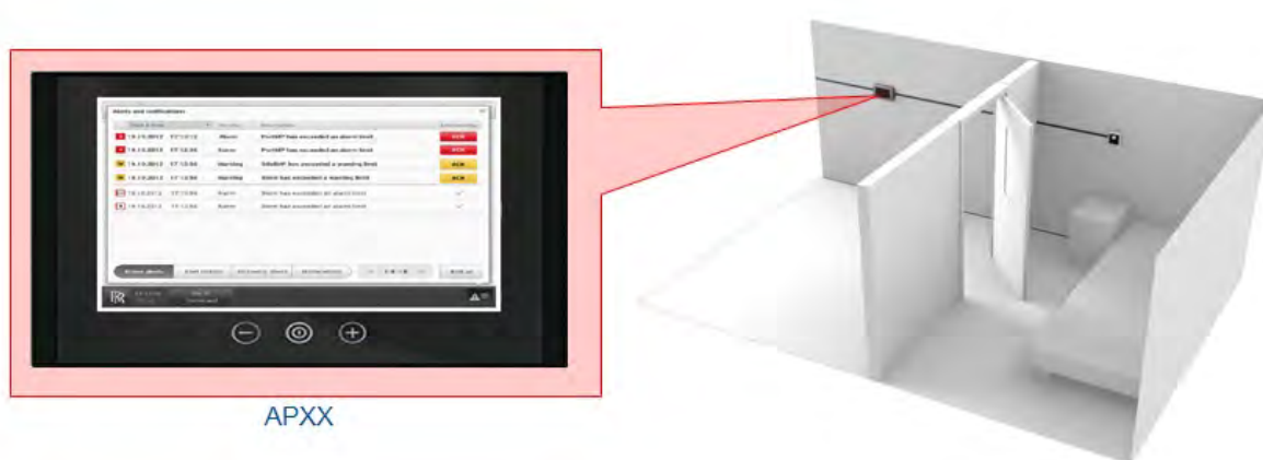
Ilustración 7.13 – Panel de extensión de alarmas
