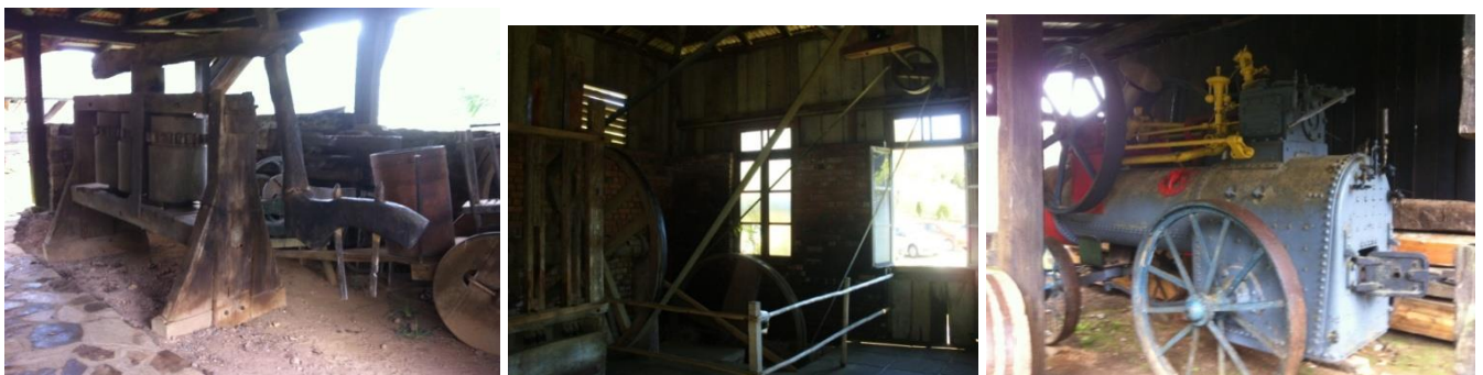
Transmissão mecânica de força motriz: tração animal, roda d'água e máquina a vapor
