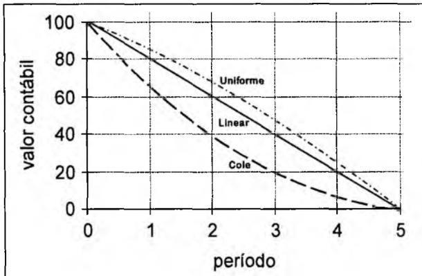
Figura 4.1 - Comparação entre os três métodos de depreciação
