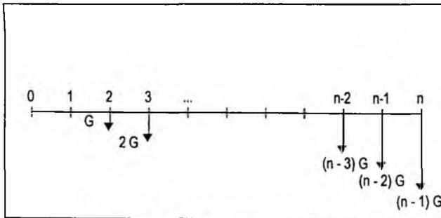
Figura 2.4 - Definição de Gradiente Uniforme
