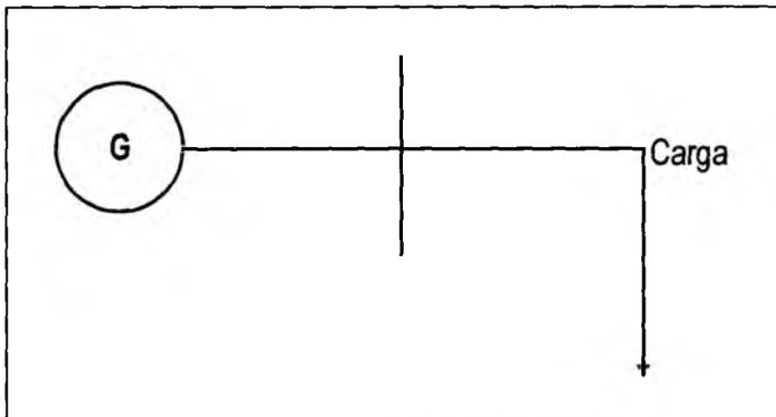
Figura 5.1 - Gerador alimentando uma carga.
