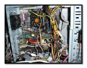
**2º Passo** é retirar a fonte de alimentação, diminuindo a quantidade de cabos no computador e liberando espaço dentro do gabinete. Para a retirada da fonte, precisamos fazer a retirada dos parafusos que se encontra na parte de trás do gabinete.
