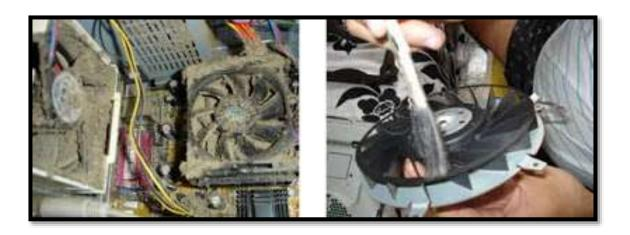
Há também a opção de realizar a limpeza do computador com um compressor de ar, onde neste caso não é necessário a remoção dos componentes, porém, temos q tomar cuidado na hora de limpar pois o compressor elimina água durante sua utilização, então não podemos deixar cair água na placa-mãe e nem nos seu componentes.
