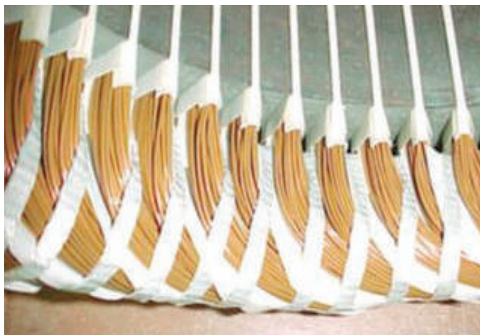
Figura 28. Cabeza de bobina típica de un motor reparado de 4 polos. Figura © EASA
