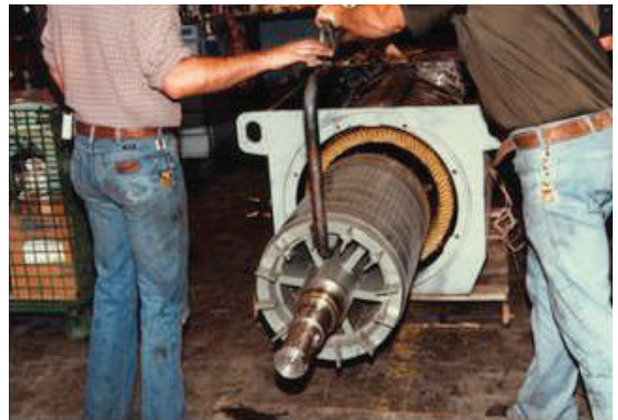
Figura 17. Extracción de rotor usando una herramienta diseñada para desmontaje de rotores.
