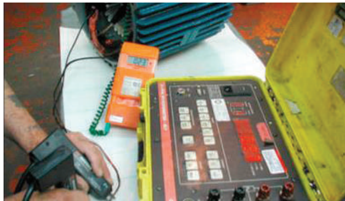
Figura 30. Medición de la resistencia de un grupo de bobinas. Note que los cables del equipo se encuentran conectados de forma segura a los alambres desnudos; también note el termómetro para medir la temperatura ambiente.
