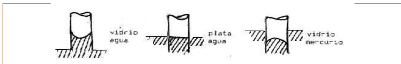
Figura 128. Meniscos. 1. Adhesión > cohesión, 2. Adhesión = cohesión, 3. Cohesión > adhesión. Tomado de Juárez y Rico. Mecánica de Suelos.
