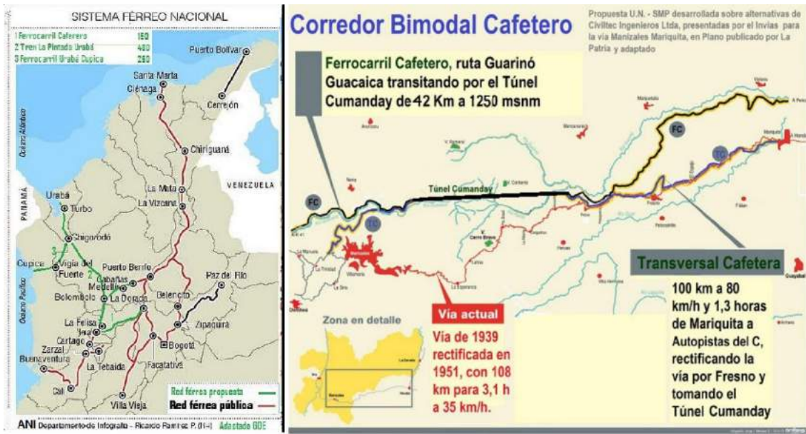
Imagen 24D. Izq. Colombia: red ferroviaria actual y propuesta. Fuente: ANI. Der. Corredor Bimodal Cafetero por el Norte del Tolima por el Túnel Cumanday de 42 km a 1250 msnm, conectando el Magdalena Centro con el Corredor del Cauca. Fuente: La Patria.
