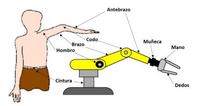
**Brazo robot:** Es un tipo de brazo mecánico, normalmente programable, con funciones parecidas a las de un brazo humano; puede ser la suma total del mecanismo o puede ser parte de un robot más complejo.
