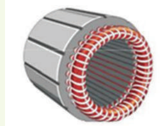
Fig 3. Forma del estator de un motor eléctrico
