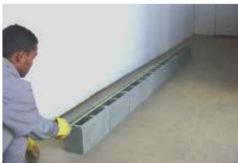
Figura 7 – Verificação de blocos dispostos em fila
