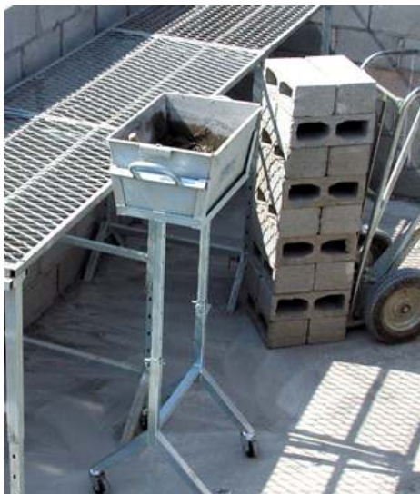
Figura 30 – Andaime metálico, suporte para caixote de argamassa e carrinho para blocos
