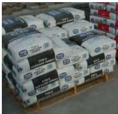
Figura 9 – Armazenamento de argamassa em pallets por tipo
