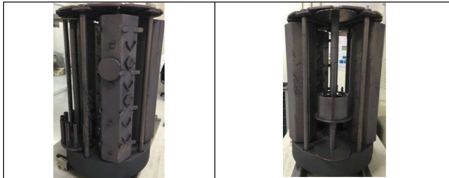
Figura 10. Carrusel con sustratos de acero M2 y D2 fuera de la cámara PVD con recubrimiento de c-AlTiN.
