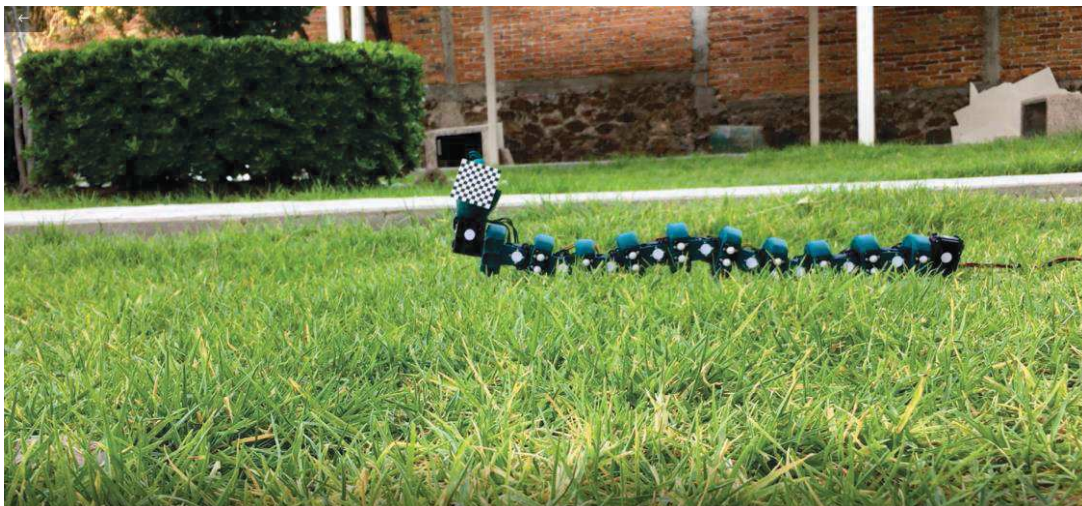
Figura 17. Robot gusano desplazándose en el pasto.
