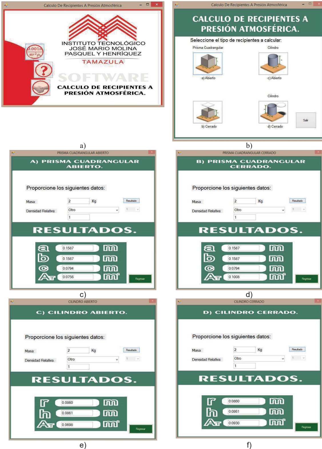
Figura 9. Maquinado: a) Interfaz del software, b) Posibles casos a analizar, c) Prisma cuadrangular abierto, d) Prisma cuadrangular cerrado, e) Cilindro abierto, f) Cilindro cerrado.
