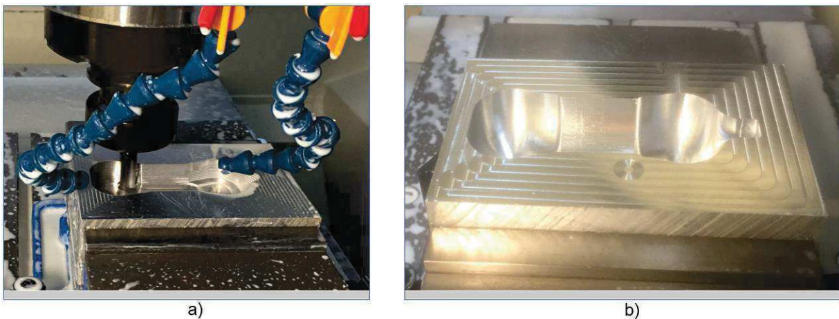
Figura 8. Maquinado: a) Desbaste con el cortador de 0.5 in y b) Acabado de 0.375 y 0.125 in de diámetro.
