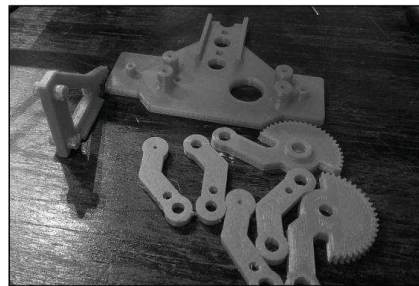
Figura 5. Componentes impresos en Prusa-i3®
