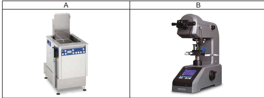
Figura 7. (A) Equipo de limpieza ultrasónico de la marca Elmasonic, (B) Equipo Micro durómetro Wilson Hardness modelo TUKON 1202.
