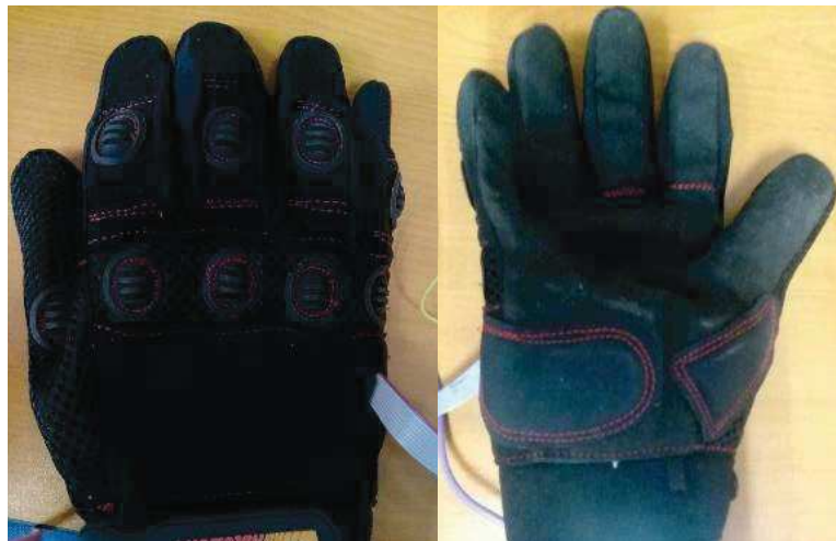
Figura 3. Guante con los sensores FSR402.
