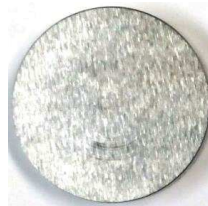
Figura 4. Probeta de acero grado herramienta M2.
