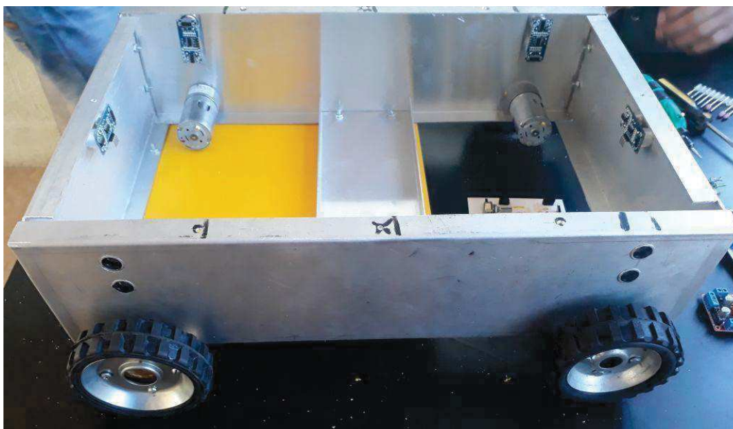
Figura 10. Chasis mostrando los 6 sensores y los motores
