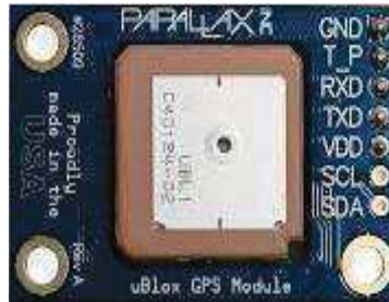
Figura 3. PAM-7Q de la compañía de Parallax's [2].
