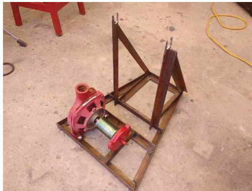
Figura 11. Base de la bicibomba terminada
