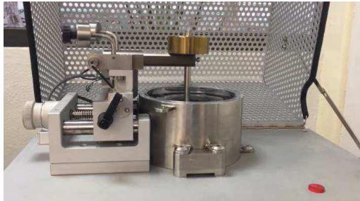
Figura 15. Tribómetro Pin-On-Disk ANTON PAAR.
