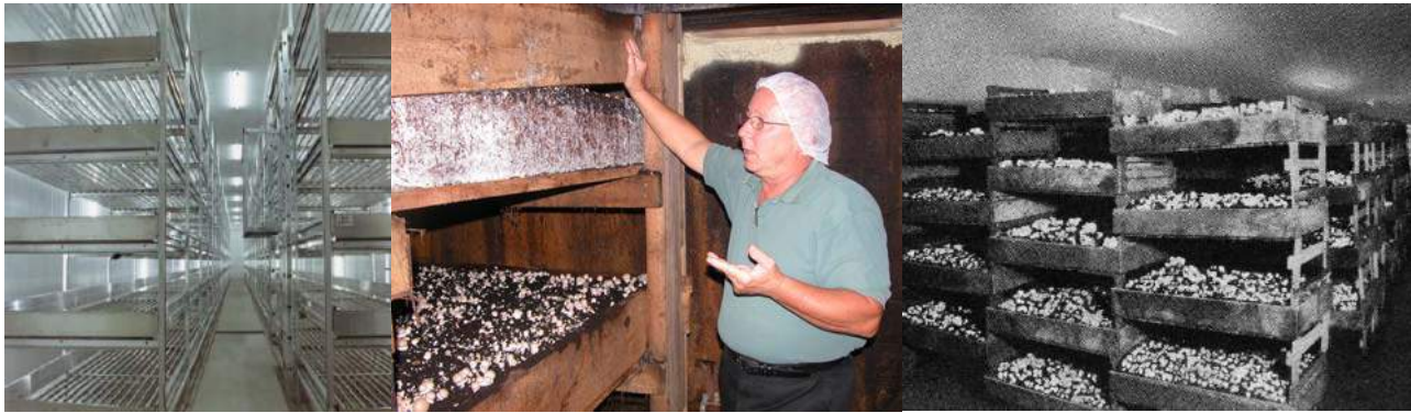
Figura 35. Estantes de acero galvanizado y de madera con bandejas fijas que caracteriza al Sistema de producción Holandés de champiñones (Fernández, 2005 y Regés, 2004).
