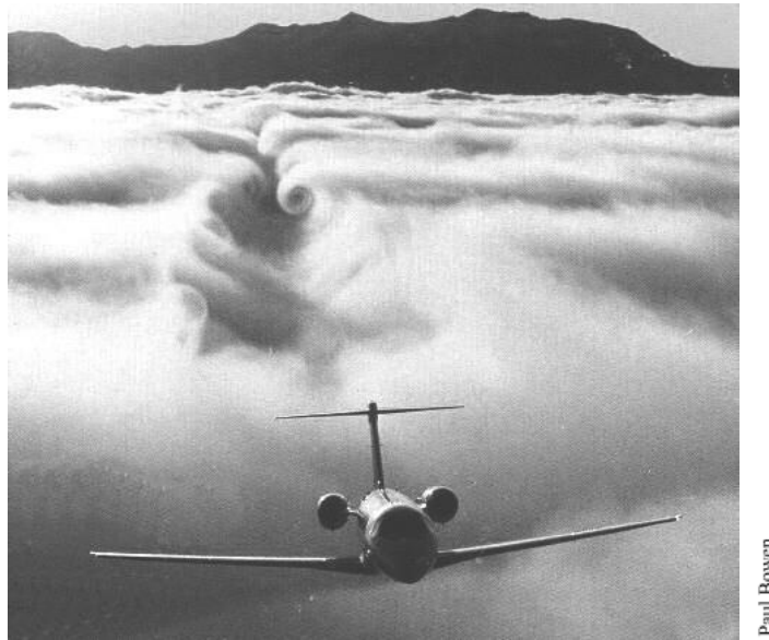
Figura 23 – “Túnel” aberto no nevoeiro pelo ar descendente.
