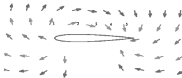
Figura 15 – Direções do escoamento (referencial estático).
