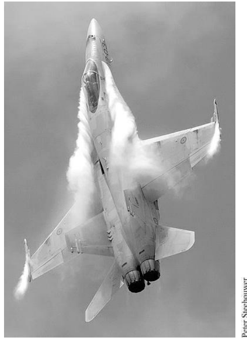
Figura 31 – Vórtices da extensão do bordo de ataque de um “F-18”
