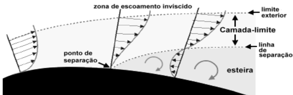
Figura 29 – Esquema da separação da camada-limite.
