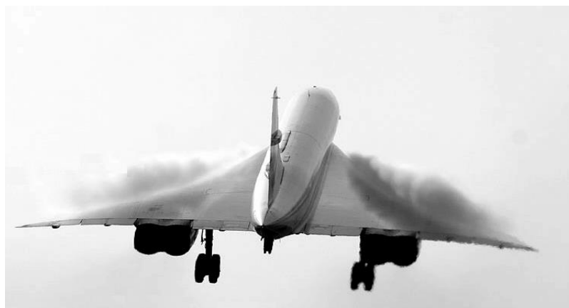
Figura 28 – Vórtices de padrão cônico no delta do Concorde.
