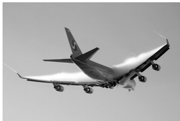
Figura 22 – Efeito da condensação de vapor-de-água.
