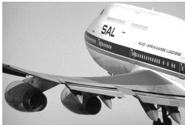
Figura 27 – Flexão alar na decolagem (“Boeing 747”).
