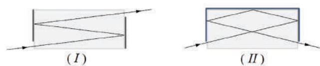
Figura 5: (I) Paralelepípedo de vidro óptico com duas faces opostas espelhadas com prata, exceto pelas duas faixas paralelas uma na base e a outra no topo, nas faces opostas. (II) Paralelepípedo similar, com três faces espelhadas, exceto pelas duas faixas paralelas na base das faces opostas.
