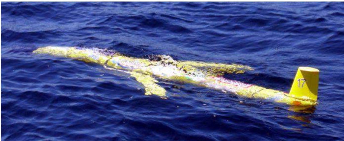
Figura 1.15. Scarlet Knight; el submarino sin motor
